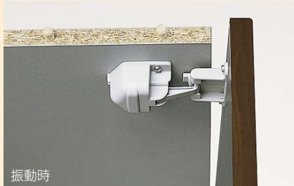
振動時 地震で揺れると、フックが作動し、開こうとする扉を ロックします。(扉を押すとロックが解除されます。)
